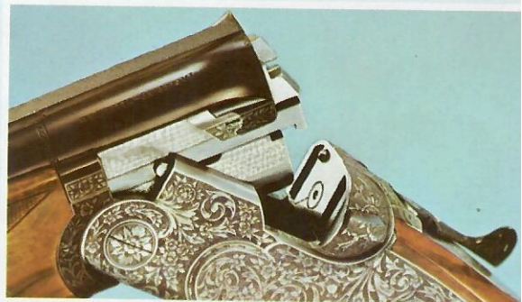
Ejector. Semplici e robusti, gli estrattori automatici, espellono con forza i bossoli esplosi.
