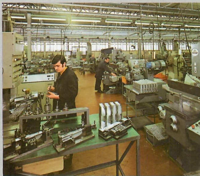
Lavorazione della culatta dell'Automatico con frese elettroniche
